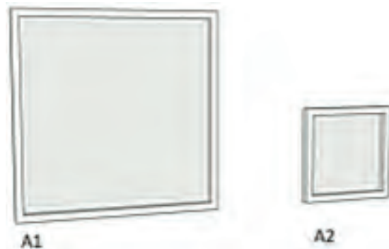
Figura 20. Proporção para o dimensionamento das aberturas: a área útil da menor abertura (A2) deve ser maior ou igual a 25% da área útil da maior abertura (A1), ou seja, A2 \geq A1 \times 0,25 . Por exemplo: se A1 tem 2m 2 , A2 precisa ter, no mínimo, 0,50m 2
