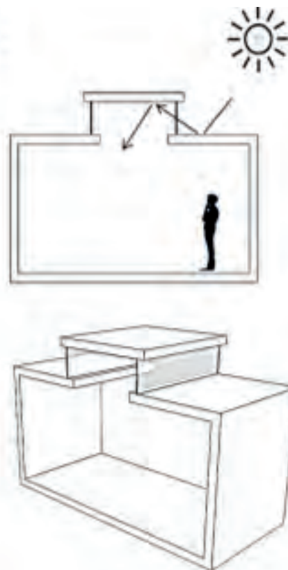
Figura 22. Representação de lanternim: em corte (acima) e perspectiva (abaixo).
