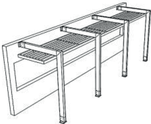
Figura 31. Sombreador externo horizontal com aletas.
